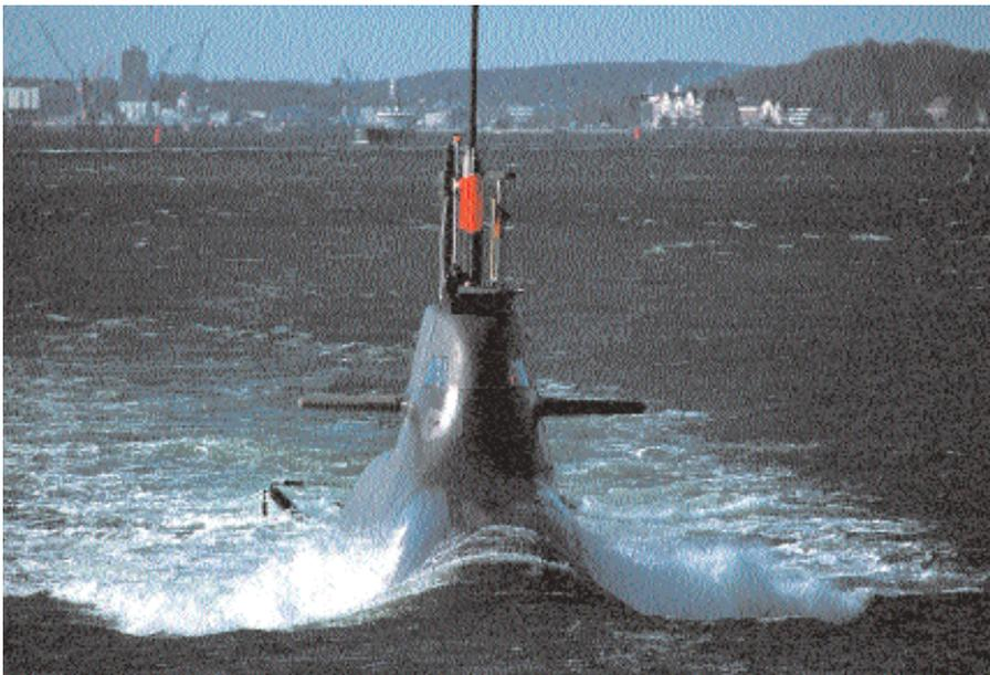
Wettpremiere: Die U-Bootklasse U212A verfügt über einen außenluftunabhängigen Antrieb auf Basis einer Brennstoffzellenanlage
